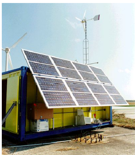
Figuur 5.1 Combineren van zonne- en windenergie
